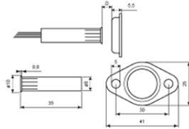
Le 416-MA permet d'installer un contact avec un encombrement réduit pour l'aimant.
